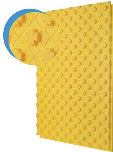
采用意大利阿莱西奥进口设备制造，严格遵守欧洲的生产工艺和标准。全新环保料EPS保温层，优质的HIPS防水膜。兼顾保温和降噪，搭配Φ10管道采用5cm管间距，散热细腻均匀，舒适感更好。
